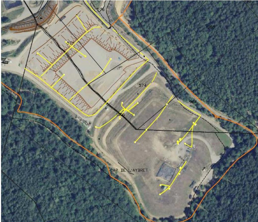
Figure 18 : Vue d'ensemble du réseau d'extraction du biogaz sur le vallon 1
